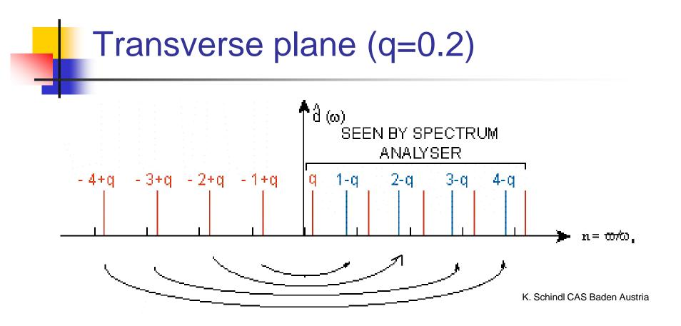
• On the spectrum analyser, we observe the « upper side bands » (USB) and the « lower side bands » (LSB (blue)).
