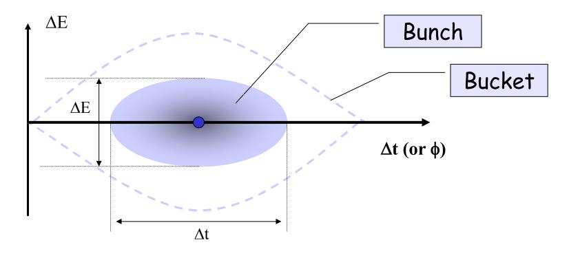
Bucket area = <a href="Iongitudinal Acceptance">Iongitudinal Acceptance</a> [eVs]
