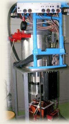
CTF3 klystron 3 GHz, 45 MW, 4.5 \mu s, 50 Hz, \eta \approx 45\%
