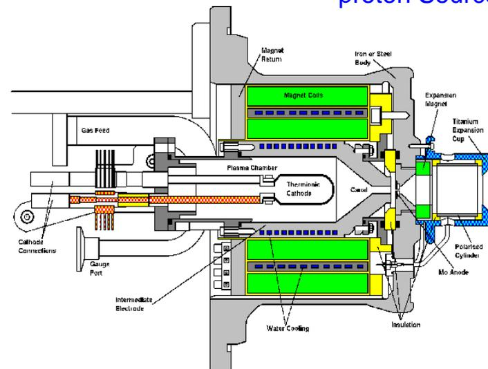
**Ion injector** (CERN Linac1)
