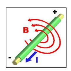
$$\int\limits_{A} \nabla \times \vec{B} \ d\vec{A} \ = \ \oint\limits_{C} \vec{B} \cdot d\vec{r} \ = \ \int\limits_{A} \mu_0 \vec{j} \ d\vec{A}$$
