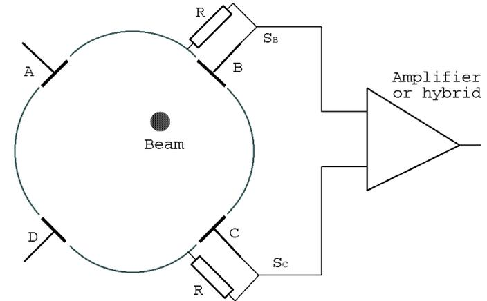
$$x = k_x \frac{(S_A + S_D) - (S_B + S_C)}{S_A + S_B + S_C + S_D}$$
