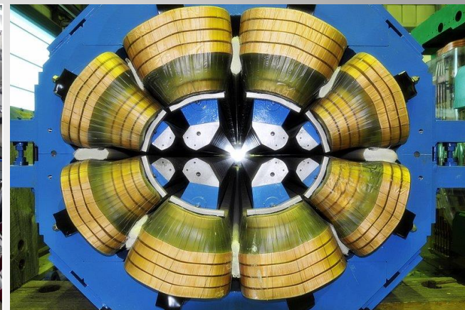
Double-aperture LHC quadrupole
