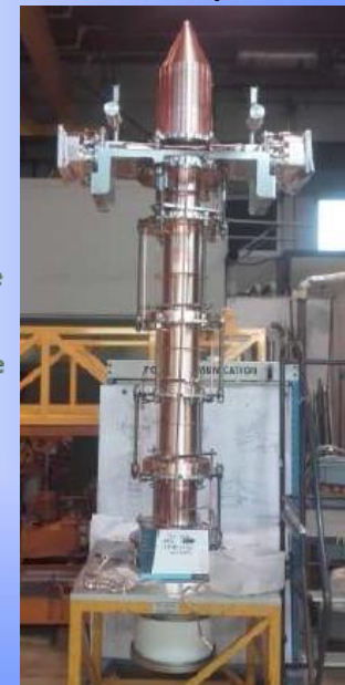
CLIC DB klystron 1 GHz, 20 MW, 150 \mu s, 50 Hz, \eta \approx 73\%
