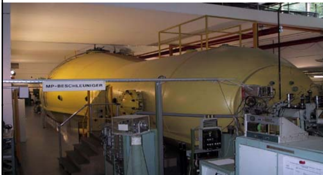
12 MV-Tandem van de Graaf Accelerator
