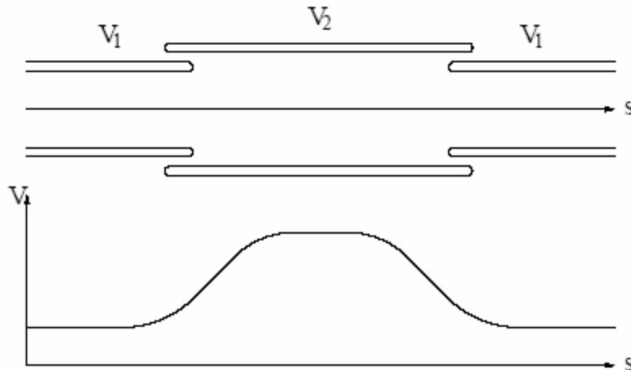
Einzel Lens: Focusing Lens for  $V_2 > V_1$  and  $V_2 < V_1$ .
