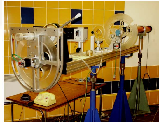
Rys.3 Oprzyrządowana ława optyczna zainstalowana w pomieszczeniu radioterapii protonowej w IFJ PAN Kraków. Widoczne są elementy układu formowania i monitorowania wiązki protonowej, układu podglądu położenia oka, układu pozycjonowania oka oraz układu do pomiaru rozkładu dawki w obszarze piku Bragga.
