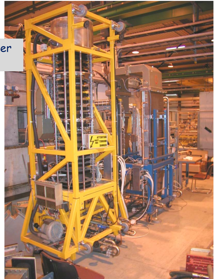
LHC 330 kW klystron. Group delay 130 ns @ 400.8 MHz. ~50 kV, 10A DC
