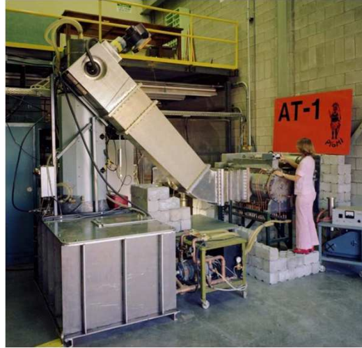
The 1 st 4-vane RFQ, Los Alamos 1980: 100 KeV - 650 KeV, 30 mA , 425 MHz
