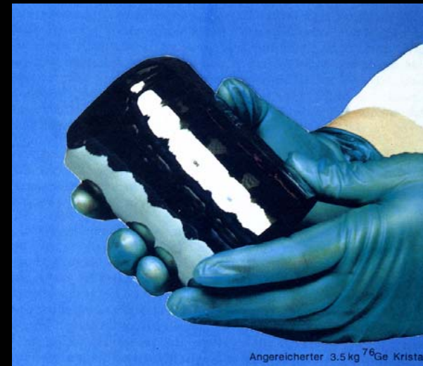
Angereicherter 3.5 kg ^{76}\text{Ge} Kristall
