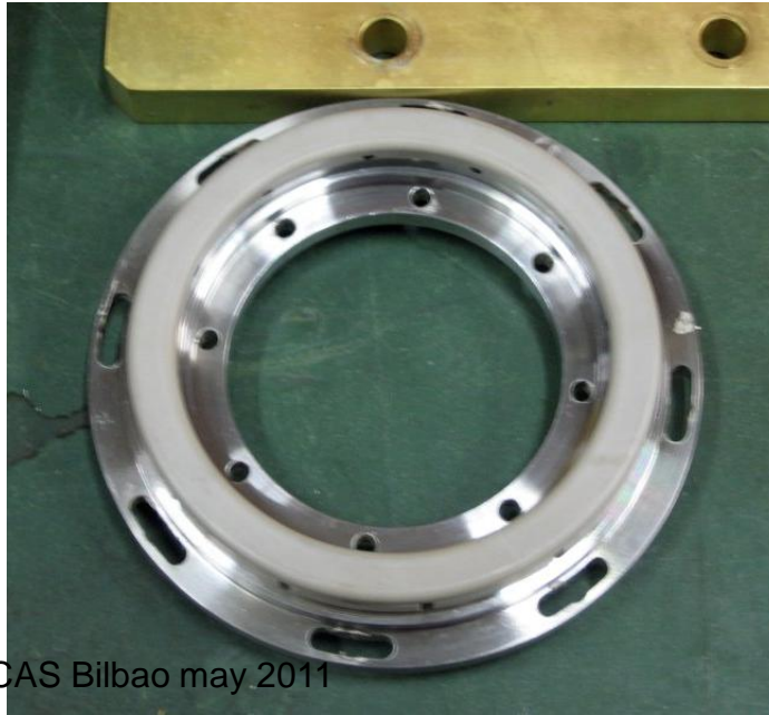
DESY TTF-3 HV capacitor
